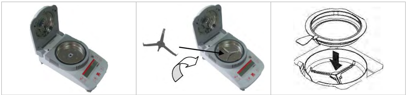
(1) Instale y coloque la pantalla contra corrientes de aire
